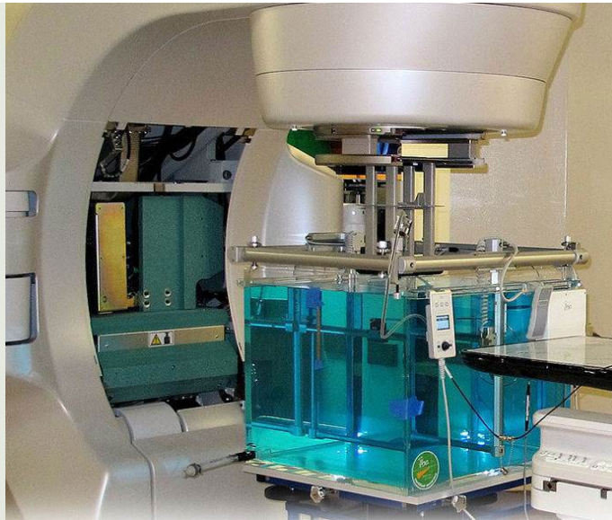
Slika 43. Visokoenergijski linearni pospeševalnik v času relativnih dozimetričnih meritev in absolutnega umerjanja. Pod glavo pospeševalnika je t. i. vodni bazen, v katerem potekajo računalniško krmiljene meritve.
